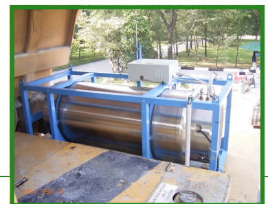
400 l LNG Storage Tank
